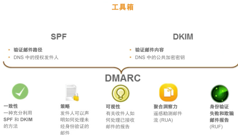
图 1-7 DMARC 基于 DKIM 和 SPF 构建以提供保护和报告
