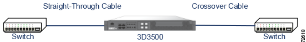
그림 2-1 Straight-Through 바이패스 연결 케이블링
