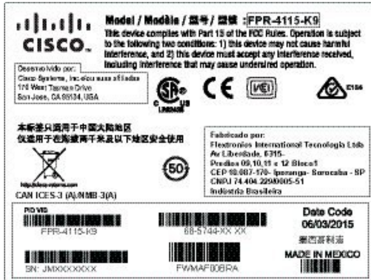
Illustration 4 : Étiquette de conformité sur le châssis 4100
