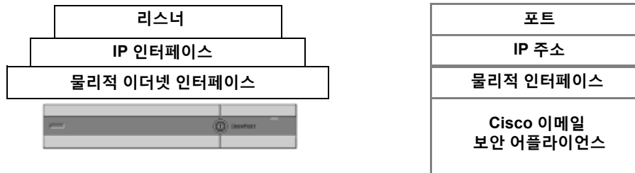
그림 5-1 리스너, IP 인터페이스 및 물리적 이더넷 인터페이스 간 관계
